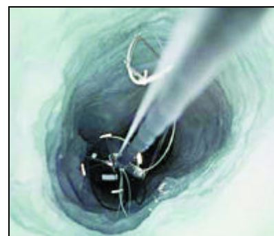
Рис.10. Монтаж гирлянды из ФЭУ в скважине, пробуренной в ледяном покрове Антарктиды.
